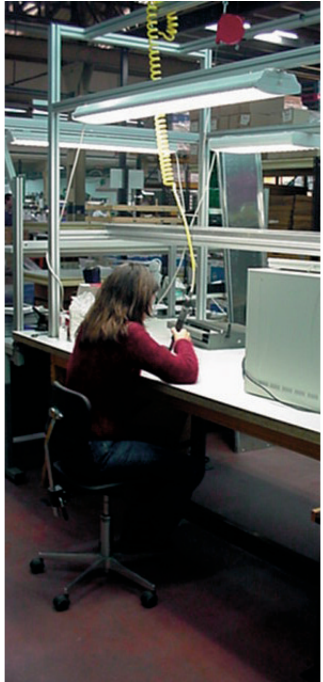
Erandio. Mesas de montaje con luminarias de refuerzo y herramientas suspendidas.
