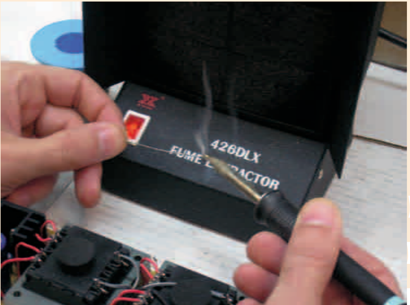
Sondika. Aspiraciones localizadas de humos. Extractor puntual para soldadura de estaño.
