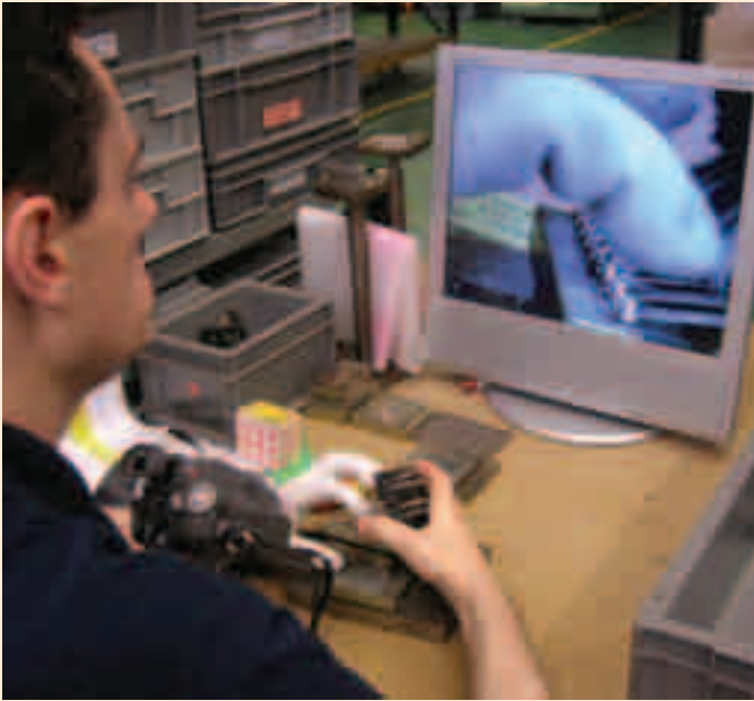
Etxebarri. Puesto de comprobación contactos. Verificación visual a través de monitores.
