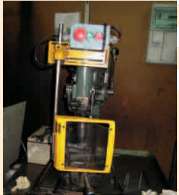
Loiu II. Protección de seguridad taladros.
