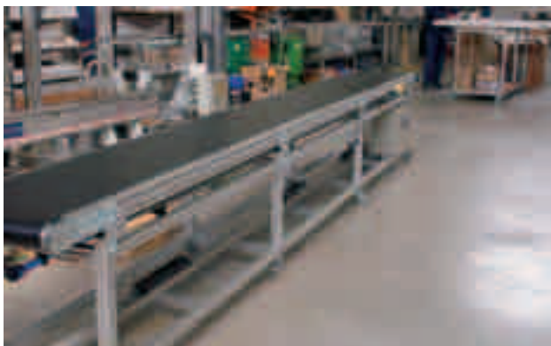
Zorrotza. Cinta transportadora de apoyo al montaje.
