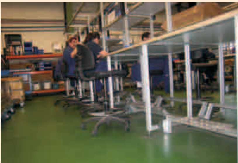
Etxebarri. Mesas de trabajo ajustables para montajes electrónicos. Reposapiés con regulación integrada en las mesas.
