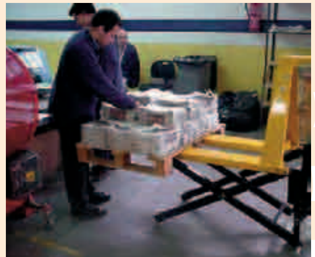
Publicidad directa. Traspaleta de tijera utilizada como plano de trabajo regulable en altura.
