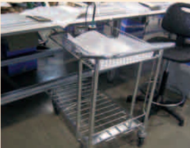
Sondika. Carros de tipo gran superficie comercial que son utilizados como planos de trabajo auxiliares y que facilitan el transporte de piecerío.
