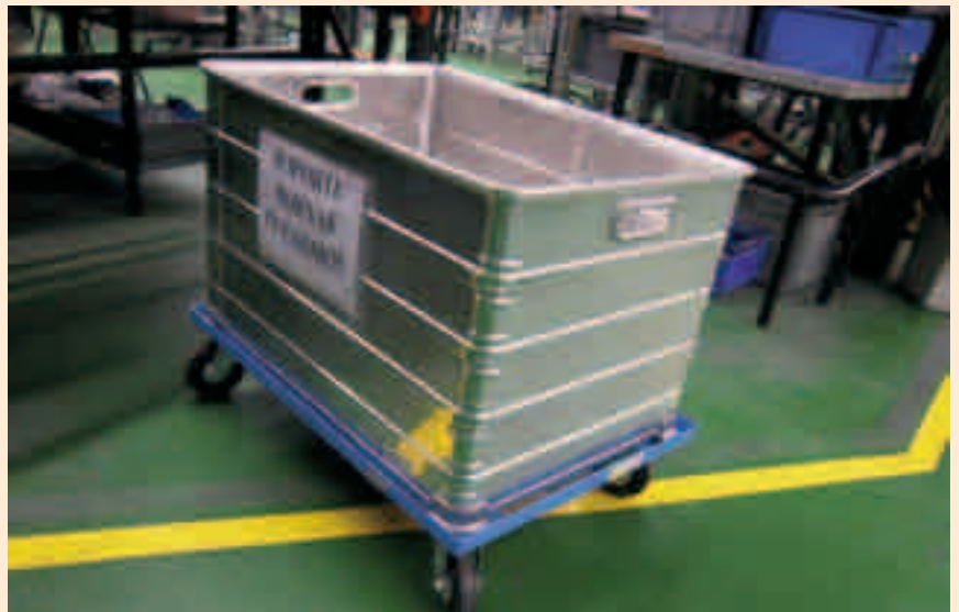
Etxebarri. Contenedores metálicos con ruedas para el manejo de material.
